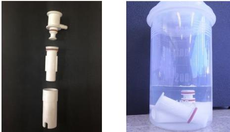
4. 洗浄溶液に浸したミルカーを水で良く洗い流し、洗浄用ブラシで各パーツの穴や内側を清掃します。
