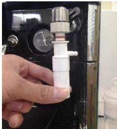
3. ミルカーを 3 つに分解して、準備した洗浄溶液に一晩浸します。
