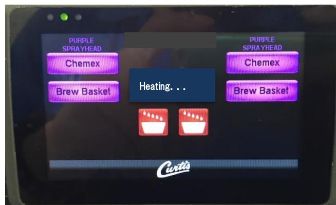
タンク内の水が設定温度に到達するまで沸き上げを行います。沸き上げが完了するとディスプレーの表示は Ready to Brew と表示され、コーヒー抽出が可能になります。
