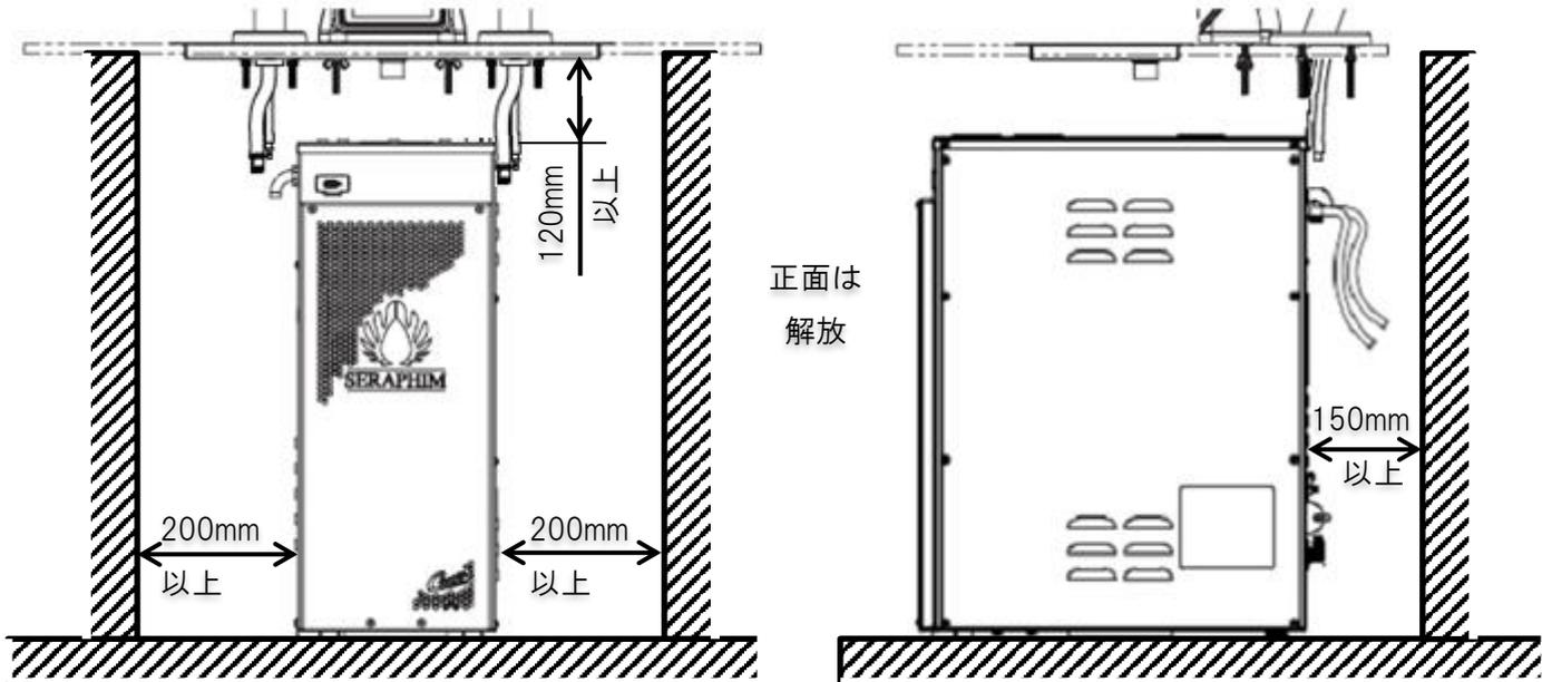
給湯部は2つの抽出ヘッドの左右中央、抽出ヘッドの配管よりも手前になるように設置してください。
