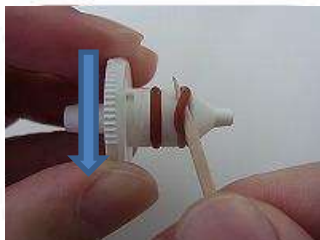
②部品を手前に回しOリングを浮かせます。
