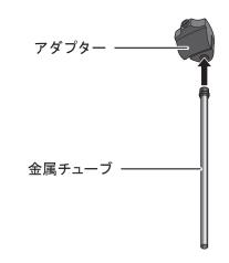
2 ステンレス容器の縁にアダプターを 取り付けた金属チューブを取り付けます。
