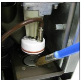
**5** ピストン底に装着しているフィルターもきれいな布で拭きます。
