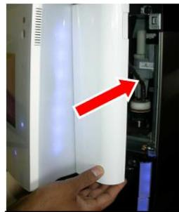
**7** 再び、前面パネルを開け、抽出シリンダー部に洗浄剤を1錠入れて前面パネルを閉じます。
